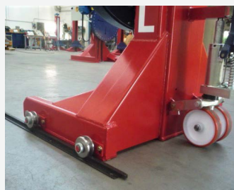
Sistema di movimentazione su binari ausiliari manuale o motorizzato
