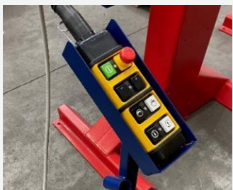
Sistema di autoapprendimento per memorizzazione movimenti semi-automatici
