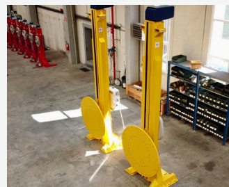
Estensione della corsa in altezza della colonna Extra stroke in column height
