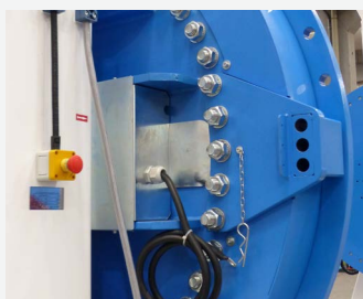
Massa strisciante per la saldatura da 400A-800A-1200A
