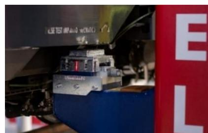
**CÁRTER DE COBERTURA METÁLICA** para la protección del motorreductor de cada columna.
