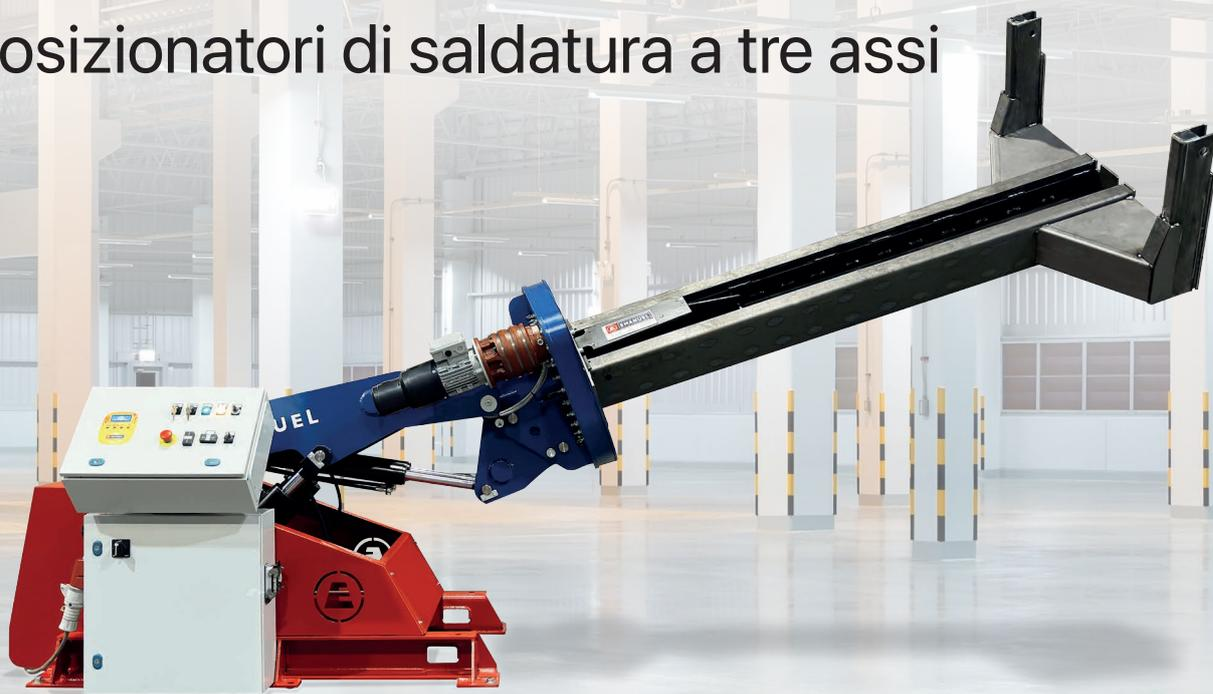
I manipolatori della serie **WP** sono posizionatori a 3 assi particolarmente indicati per effettuare operazioni di saldatura e montaggio.
