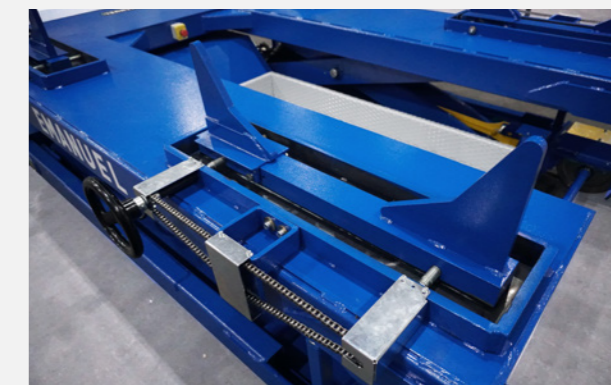
SISTEMA DI TRASLAZIONE MANUALE / MOTORIZZATA DI UNO O DI ENTRAMBI GLI ASSI DEL GRUPPO ROTAIE Translation system manual or motorized of one or both axes
