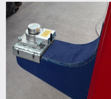
SISTEMA DI CELLE DI CARICO PER LA PESATURA Loading cell system for weighing
